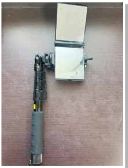
▲自製場檢勤務用車底檢查器。
