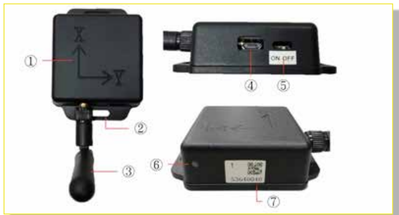
▼ UTM系統所開發的OBU，重62公克 XY軸圖示②固定座 ③LoRa天線④Micro USB充電孔⑤電源開關 ⑥態燈⑦OBU編碼 (將指定給個人/公司)
