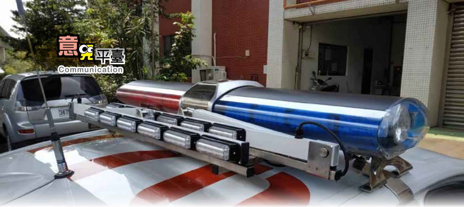
▲ 電動升降LED桿式補助警示燈收回狀況。
