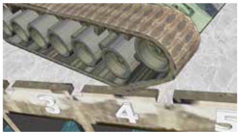
▲ 恆春戰車翻覆案模擬戰車碰撞護欄角度之情形。
