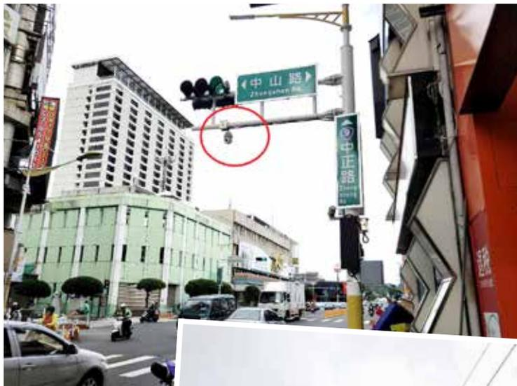
▲▶▼車潮尖峰熱點場域設置科技執法設備—車牌辨識系統，能動態偵測判讀車輛是否違停。
