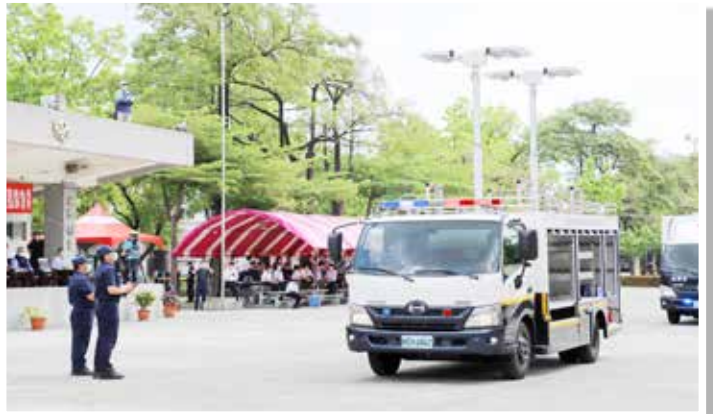
▲強力照明車燈柱採三節伸縮式照明設備，可作左右旋轉320度或俯仰320度角度旋轉，並視現場需求面積升高至適當位置提供蒐證工作之照明度。
