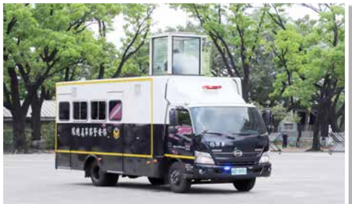
▲指揮車上設有觀測指揮平臺，升降平臺以油壓馬達驅動，並以線控器操作分別升降人員防護罩及站立平臺，可推升防護罩及站立人員1名。
